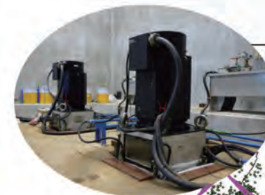
ACROSSの震源装置
